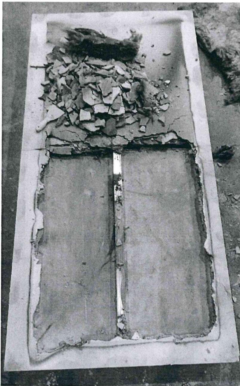
Фото 2. Образец после испытания, обогреваемая сторона (демонтаж, обследование).
